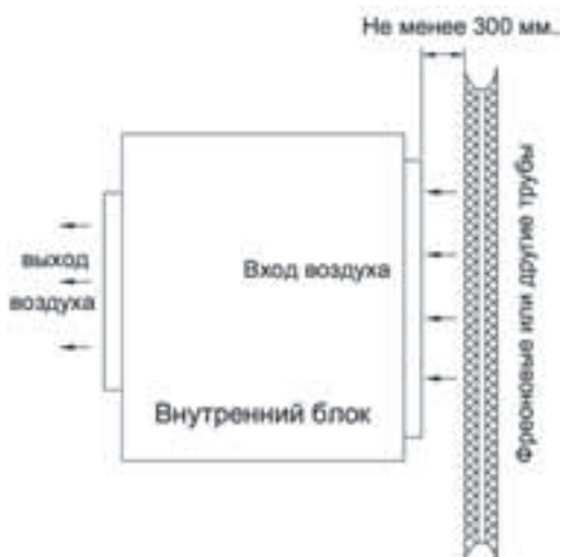
Рис. 6.5. Взаимное расположение фреоновых труб и внутреннего блока
