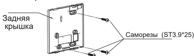
**Вариант 2:** используйте два самореза М4Х25 что бы закрепить заднюю крышку проводного пульта на распределительной коробке и один саморез ST3.9\*25 для крепления к стене.
