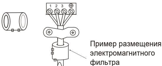
Пример размещения электромагнитного фильтра
