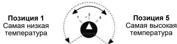
Термостат в Вашем винном шкафу контролирует только процесс охлаждения. Если Ваш винный шкаф оснащен системой «Зима» и предназначен для использования в неотапливаемом помещении, система обогрева настроена на производителем и Вам нет необходимости ее регулировать.
