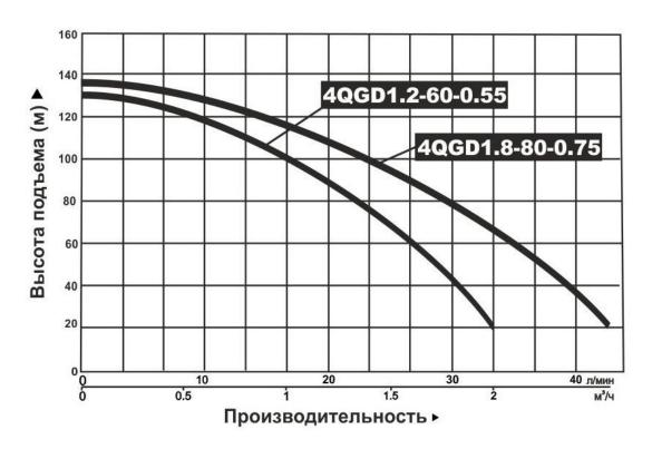
Внимание! Расчетным оптимальным параметрам работы насоса соответствует центральная область графика гидравлической производительности.
