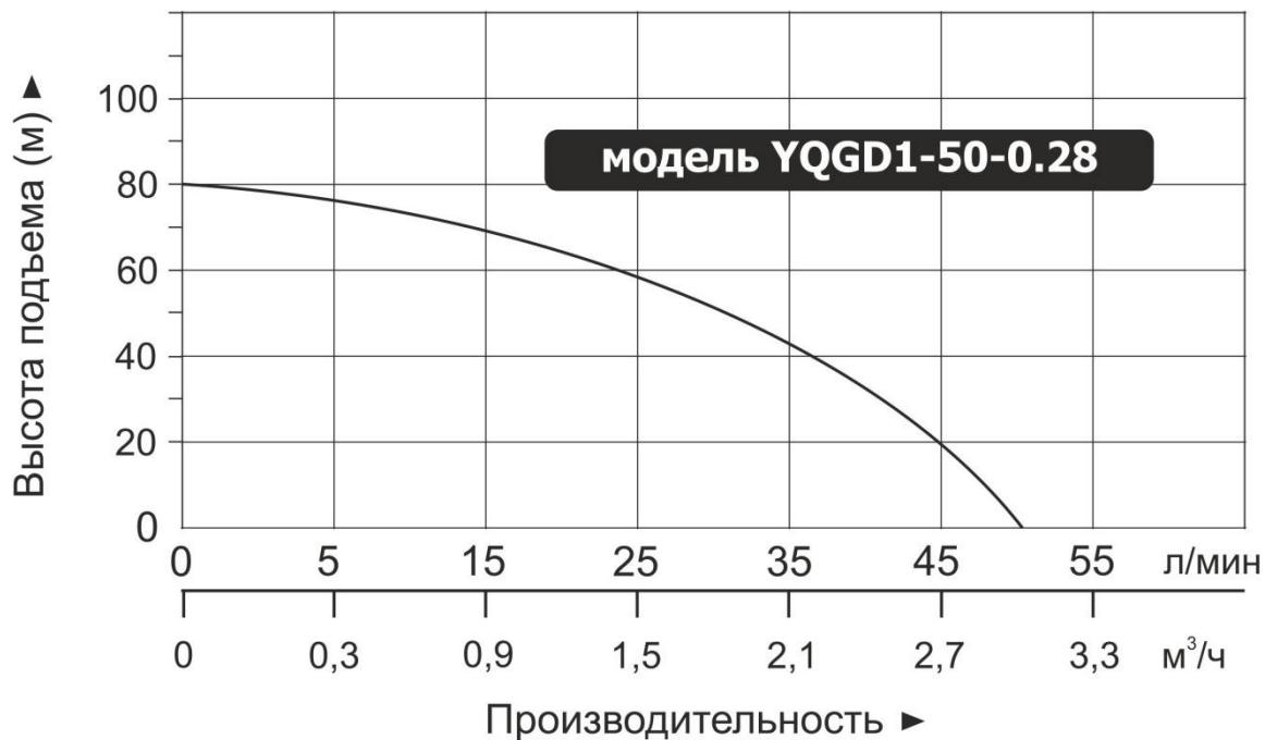
**Внимание! Расчетным оптимальным параметрам работы насоса соответствует центральная область графика гидравлической производительности.**
